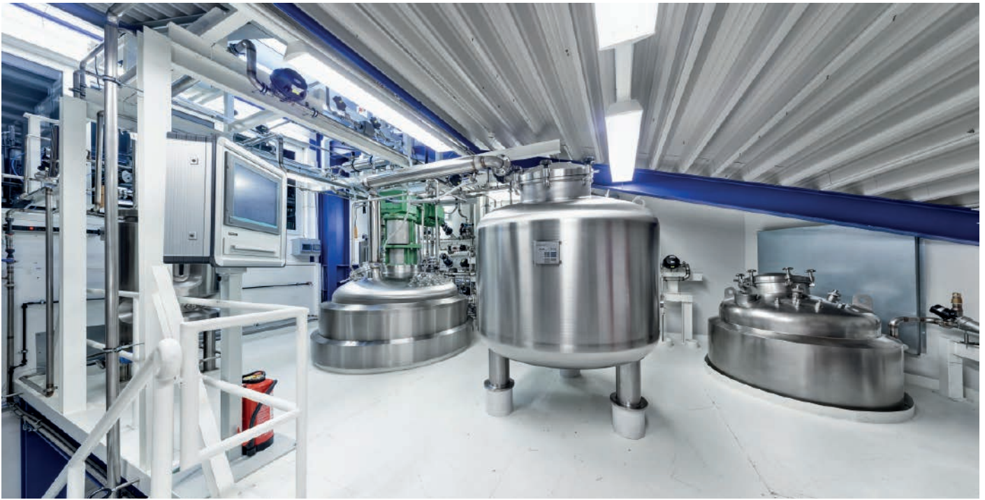
■ Abb. 1: Die Fermentationsanlage zur Produktion von humanen Milch-Oligosacchariden im Multi-Tonnen-Maßstab bei Jennewein Biotechnologie.
